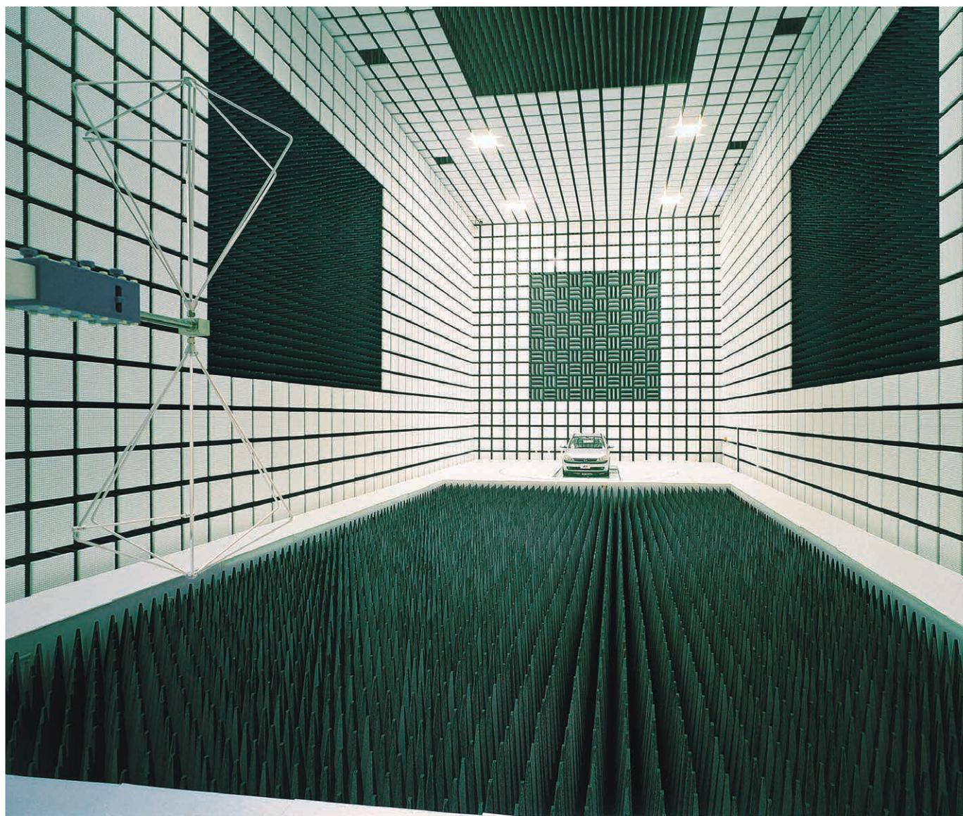
電波暗室／川里工場(埼玉県鴻巣市)にある日本最大級のアンテナ測定設備
