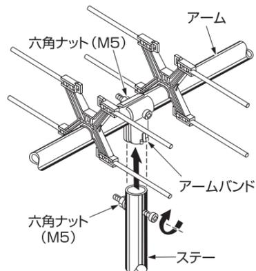
アームバンドとステーに取付けられている六角ナット (M5) をゆるめ、図のような方向でアームバンドにステーを差し込んでください。次にアームとステーの接合部にすき間がないことを確認した後、所定の締付トルクで六角ナットを締付けてください。
