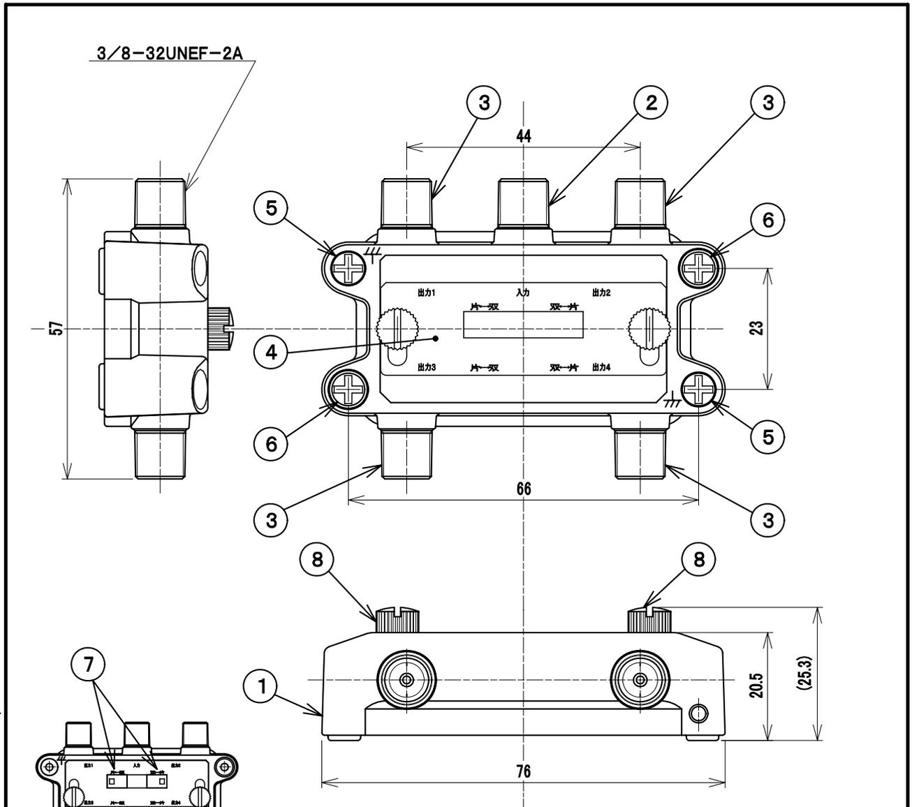
スイッチ切換時はねじをゆるめて銘板をスライドさせる。
