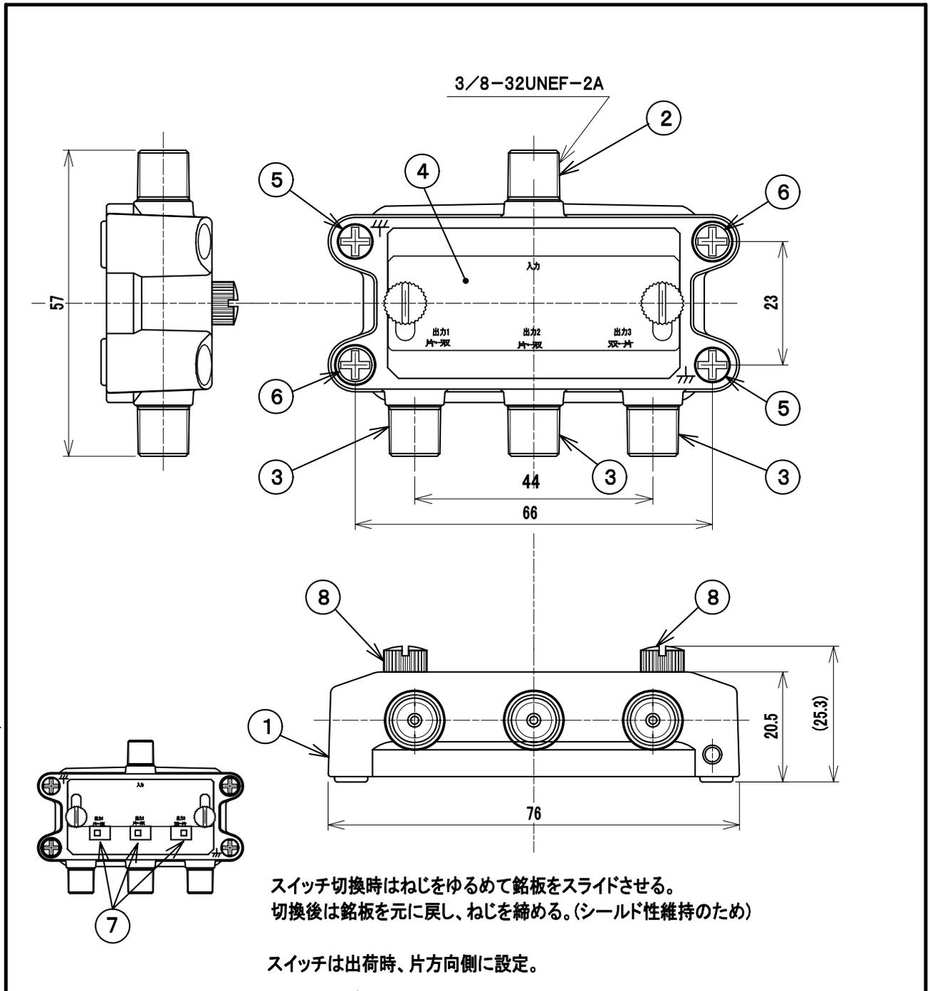
スイッチ切換時はねじをゆるめて銘板をスライドさせる。
