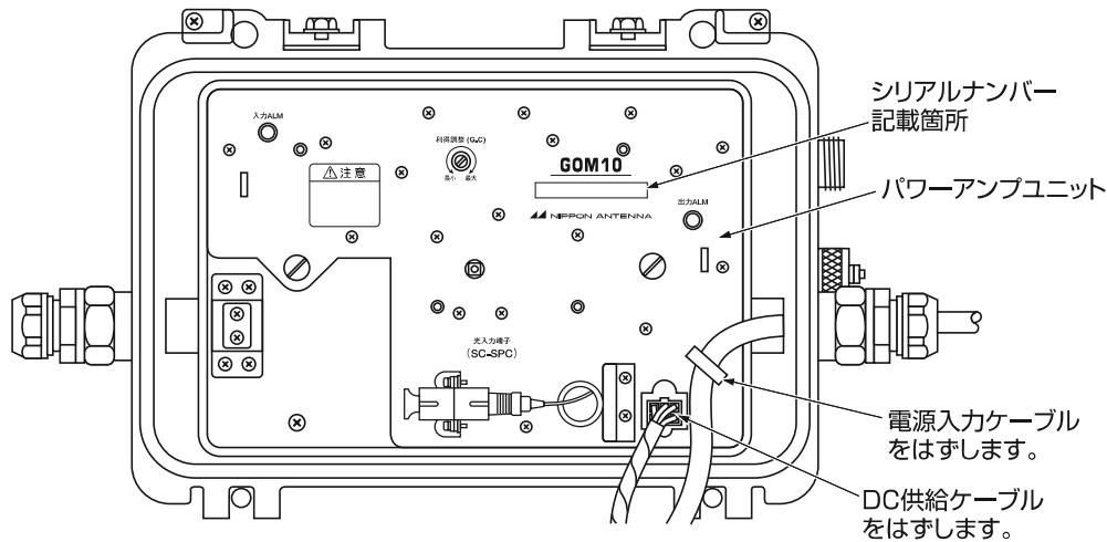
2. ユニット固定ねじを緩めてから、パワーアンプユニットを手前へ取りはずします。
