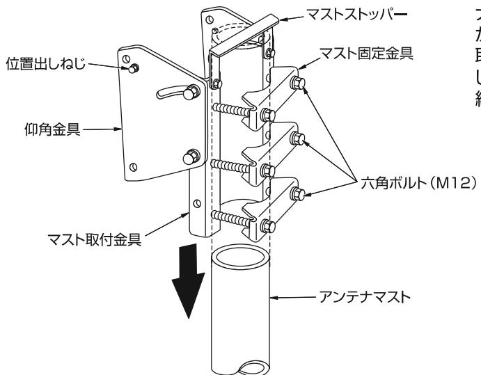
六角ボルト(M12)をゆるめ、図のようにアンテナマストの上部から挿入します。アンテナマストがマストストッパーに当たるまで差し込み、マスト取付金具セットを固定金具で取り付け(仮止め)してください。ここでは締付トルク約5.2N・mで締め付けてください。
