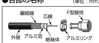
防水キャップは必ず先に同軸ケーブルに通してください。
