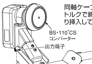
同軸ケーブルをコンバーター出力端子に接続し、指定のトルクで締付けた後、防水キャップを下図のようにしっかりと挿入して完了です。
