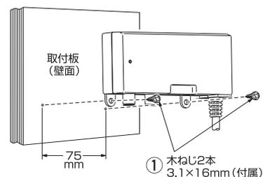
付属の木ねじは15mm厚の盤用木板 (ベニア合板) 用です。他の材質面へ取付ける場合は適切なねじをご使用ください。
