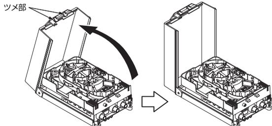
ツメ部をはずし、上へゆっくり持ち上げてください。カバーの開度は2段階構造になっています。カバーを閉める際は、ファイバー、電源コードを挟まないように十分注意してください。
