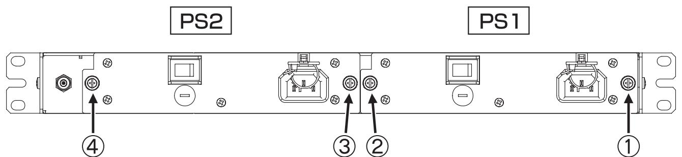
PS1のユニットをはずす場合、上図①②のねじ、PS2のユニットをはずす場合、上図③④のねじをはずします。
