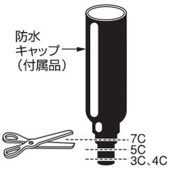
防水キャップは必ず先に同軸ケーブルに通してください。
