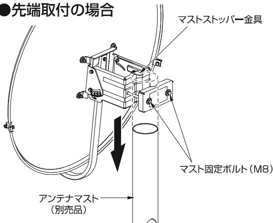
**ポイント** 適合マスト径は、 $\phi 48.6\sim\phi 89.1\text{mm}$ です。
