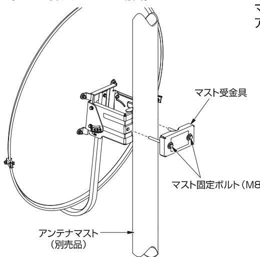
アンテナマストの中間に取付ける場合(上から挿入できない状態)は、マストストッパー金具の向きを90°程度かえます。
