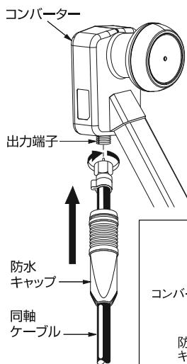
同軸ケーブルをコンバーター出力端子に接続し、指定のトルクで締付けた後、防水キャップを下図のようにしっかりと挿入して完了です。
