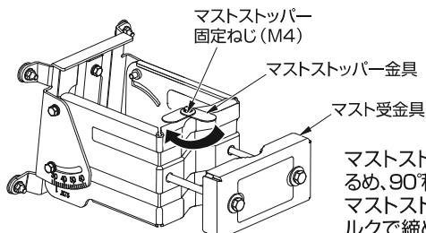
マストストッパー固定ねじ(M4)をゆるめ、90°程度向きをかえます。その後、マストストッパー固定ねじを指定のトルクで締め付けてください。
