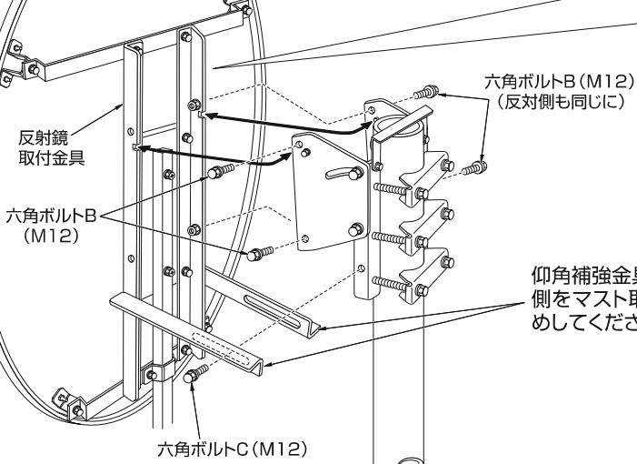
③で固定した仰角金具の位置出しへ、反射鏡取付金具の切り込みを引っ掛け、六角ボルトB(M12)を指定のトルクで締め付けてください。(計4ヶ所)
