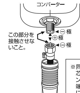
\*同軸ケーブルの芯線(+極)をコンバーター出力端子外側の-極に接触させるとショートします。
