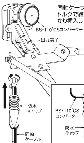
**△注意** F型接栓の締め付けが弱いと受信不良の原因となり、強すぎるとコンバーターを破損することがあります。
