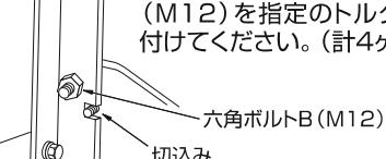
仰角補強金具の丸穴側を反射鏡取付金具に、長丸穴側をマスト取付金具に六角ボルトC(M12)で仮止めしてください。
