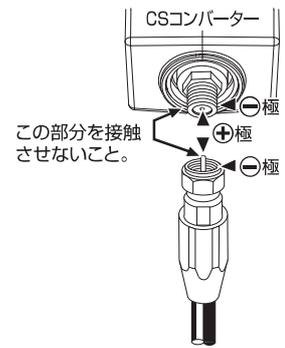
※中心コンタクト(⊕極)をCSコンバーター出力端子外側の⊖極に接触させるとショートします。
