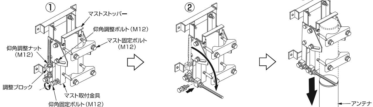
①仰角固定ボルト(M12)をいったん取りはずします。仰角調整ナット(M12)2個をゆるめます。
