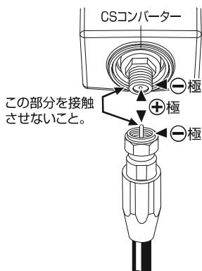
\* 中心コンタクト(+極)をCSコンバーター出力端子外側の-極に接触させるとショートします。
