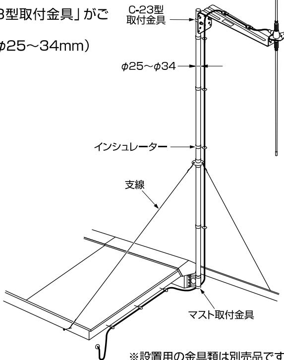
アンテナは上図の様にエレメントを縦向きにして設置して、横向きには設置しないでください。
