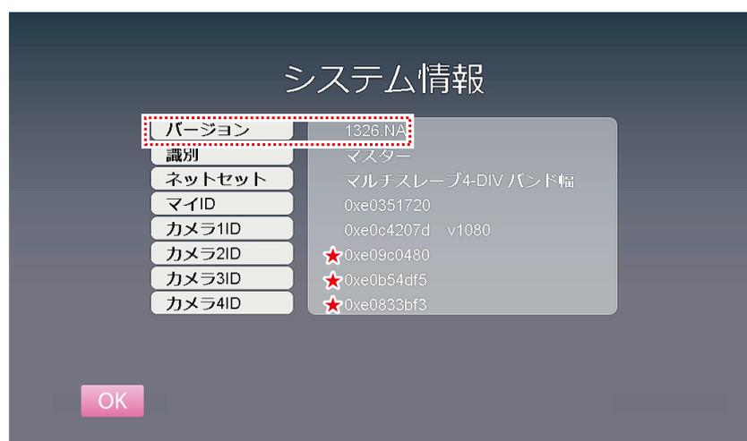
上記赤破線枠内のバージョンを示す数字が最新バージョンになっていることを確認しモニターのアップデートは完了となります。
